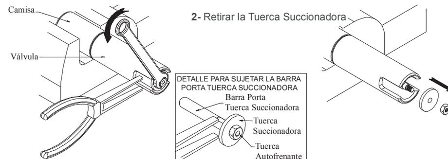
3- Sujetar la Válvula con una llave para caño y desenroscarla (si ni afloja, darle unos golpes con un martillo en la zona de la rosca) Tener cuidado de no deformar la Válvula
